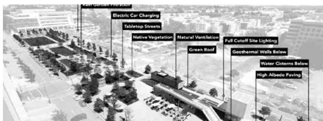
Hình 5. Canal Park (Washington D.C., Hoa Kỳ) Cải tạo bến xe buýt cũ thành công viên xanh tái sử dụng nước mưa với hệ thống vườn mưa và hồ chứa ngầm (Nguồn: OLIN Studio, 2012)
