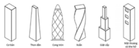
Hình 6. Hình dạng nhà cao tầng giảm thiểu lực tác động của gió ở mức độ tổng thể
